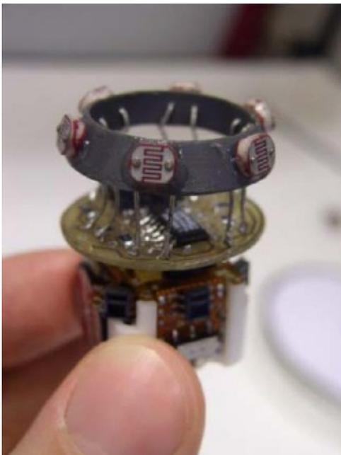
**Fig.5.** Etage de capteurs ajouté sur le mini-robot ALICE
