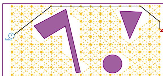
FIGURE 1.24 – Construction du graphe de déplacement
