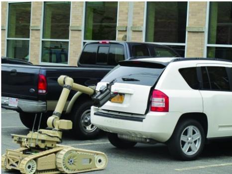
FIGURE 1.3 – iRobot-710-Warrior : robot chenillard téléopéré, équipé d’un bras et d’une pince
