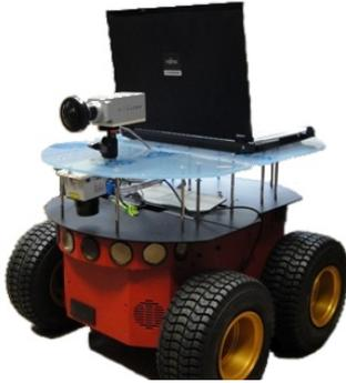
FIGURE 1.1 – Pioneer : robot quadricycles développé par Adept MobileRobots
