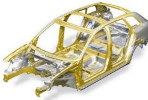
**Figure 5. Châssis d'un véhicule**
