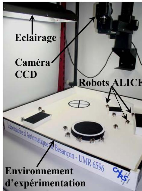
FIG. 8.1 – Plate-forme expérimentale
