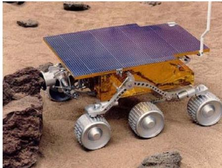
FIG. 1.2 – Robot mobile "Sojourner" utilisé pour la mission Pahtfinder de la NASA
