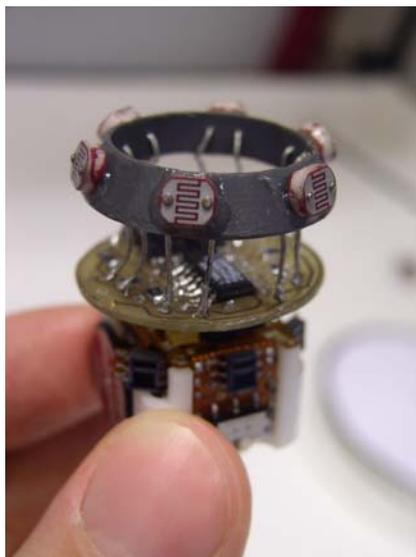
FIG. 8.8 – Étage capteurs ajouté à ALICE
