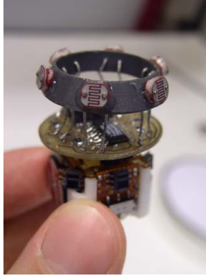
FIG. 8.8 – Étage capteurs ajouté à ALICE
